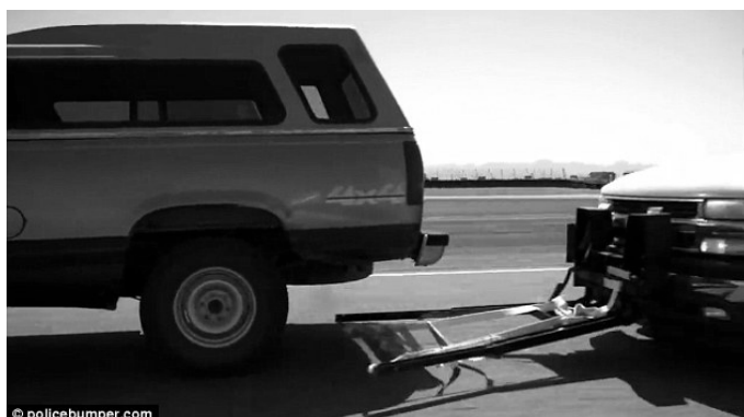
Рис. 4. Технічний засіб примусової зупинки транспортних засобів “GRAPPLER” Леонарда Стока
