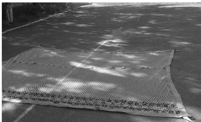
Рис. 2. Технічний засіб примусової зупинки транспортних засобів “Мереживо”
