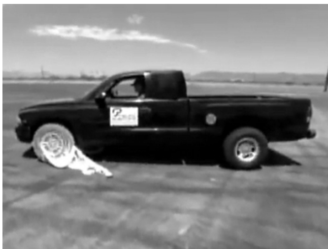
Рис. 3. Технічний засіб примусової зупинки транспортних засобів Арізонської компанії Pacific Scientific – “Pit-BUL”
