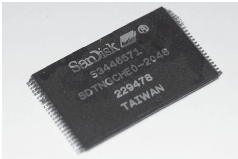
Рис. 22 Микросхема Nand Flash производства San Disk
