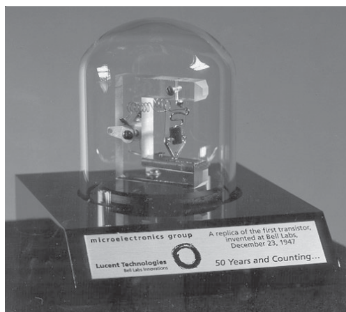
Рис. 1. Копия первого биполярного транзистора, представленного в 1947 году
