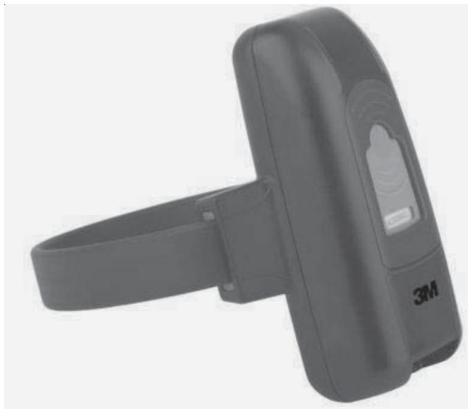
Система дозволяє визначати зони, які включаються в контролювану область або виключаються з неї. Пристрій кріпиться на нозі правопорушника (як жінок, так і чоловіків). За допомогою вібрації і світлодіодної індикації система повідомляє правопорушнику про певні події. Можна віддалено перемикати режими інтенсивності повідомлень шляхом завантаження або автоматично, шляхом визначення бази правил програми.
