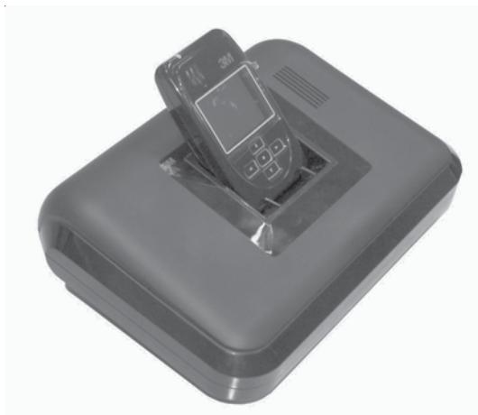
Такий стаціонарний контрольний пристрій має спеціальний ложемент для вставляння мобільного контролльного пристроя. При цьому до диспетчерського центру (також каналами GSM або ТМЗК) надходить сигнал, що мобільний контрольний пристрій знаходиться “вдома”, а контроль електронного браслета відбувається за допомогою використання стаціонарного контролльного пристроя. Крім цього, відбувається заряджання акумуляторної батареї мобільного контролльного пристроя.
