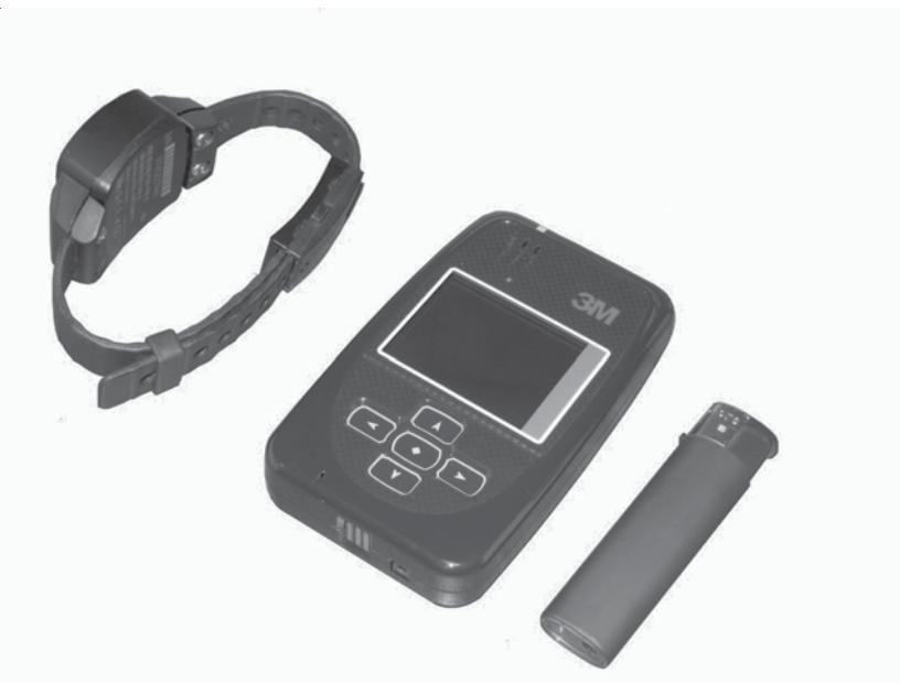
Пристрої відстежують пересування правопорушників за межами будинку за допомогою GPS-технології й передають дані за допомогою протоколу GPRS межами стільникового зв'язку.
