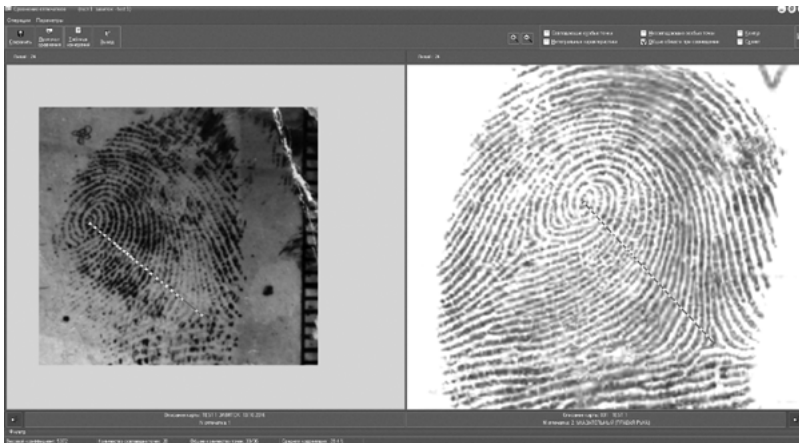
Рис. 11. Рабочее окно СПС в режиме проведения сравнительного исследования с активированным инструментом подсчета количества папиллярных линий, пересекаемых прямой. Результат выводится в режиме реального времени в поле над изображениями
